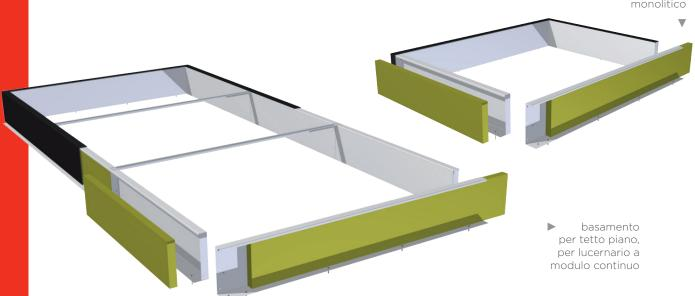
Basamenti, da comporre in opera, per installazione su coperture piane, realizzati con sezione a C in lamiera di acciaio con finiture cromatiche, altezza e pannello di coibentazione in poliuretano personalizzabili in funzione delle esigenze di progetto. Il basamento da comporre in opera, progettato sempre in 3D sia per lucernari monolitici che per i continui, garantisce un'ottimizzazione di imballo e trasporto. Fissaggi e dettagliate istruzioni di montaggio sempre inclusi.
