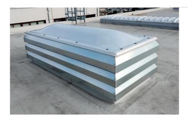
Basamento per la ventilazione continua di facile montaggio grazie alla dettagliata progettazione in 3D, composto da alette sagomate a Z da fissare a elemento di struttura, il tutto da installare su sottostante basamento impermeabilizzato. Dimensioni e finiture personalizzabili.
